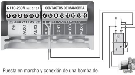
Puesta en marcha y conexión de una bomba de velocidad variable, ver sección 11 - **Bomba de velocidad variable**
