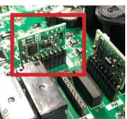
Comprueba que el chip esté enchufado correctamente y si el LED verde está parpadeando (etiqueta CL hacia abajo)
