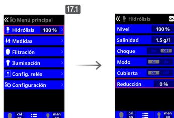
**17.1** Cubierta: Si el DA-GEN® funciona con una bomba de velocidad variable y si está conectado a una cubierta, la velocidad de filtración subirá automáticamente a velocidad "media" de manera automática cuando se abra la cubierta (ver velocidad de filtración en capítulo E del manual de servicio) Poner la reducción del valor a "0".
