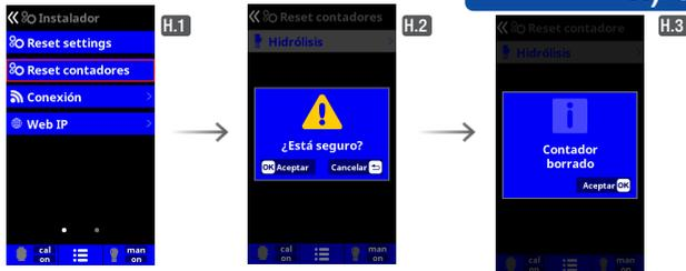
**H.2 Resetear contadores:** Existen dos niveles de las horas de funcionamiento que graban las horas de trabajo de los componentes y dispositivos.
