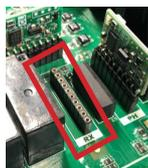
Comprueba que el chip esté enchufado correctamente y si el LED verde está parpadeando (PH/RX etiqueta en el lado izquierdo)
