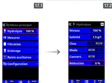
**17.1 Couverture:** Si sur le DA-GEN® une pompe à vitesses variables (chapitre 11) a été sélectionnée, que le contact de la couverture a été branché et l'option Couverture enclenchée, la pompe de filtration marchera à la vitesse moyenne (couverture ouverte). (Ceci doit être configuré selon le chapitre E). Laissez Reduction à 0%!
