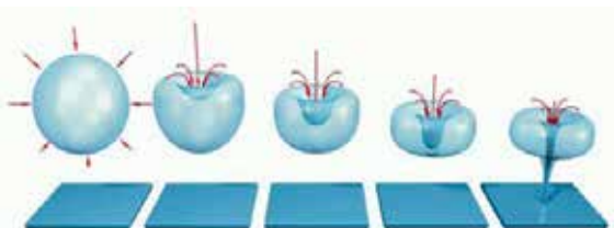
Nano processus d'implosion des bulles de vapeur – C'est de cette manière que ZPM peut désinfecter l'eau.
